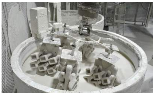
Direkte Schlickerüberwachung im Fass
