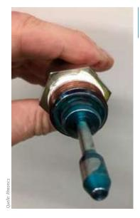
Abbildung 2: Der SRV-Sensor nach der Viskositätsmessung der Druckfarbe Cyan
