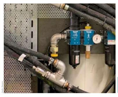
Abbildung 4: Zwei in einer Druckmaschine installierte SRV-Sensoren
